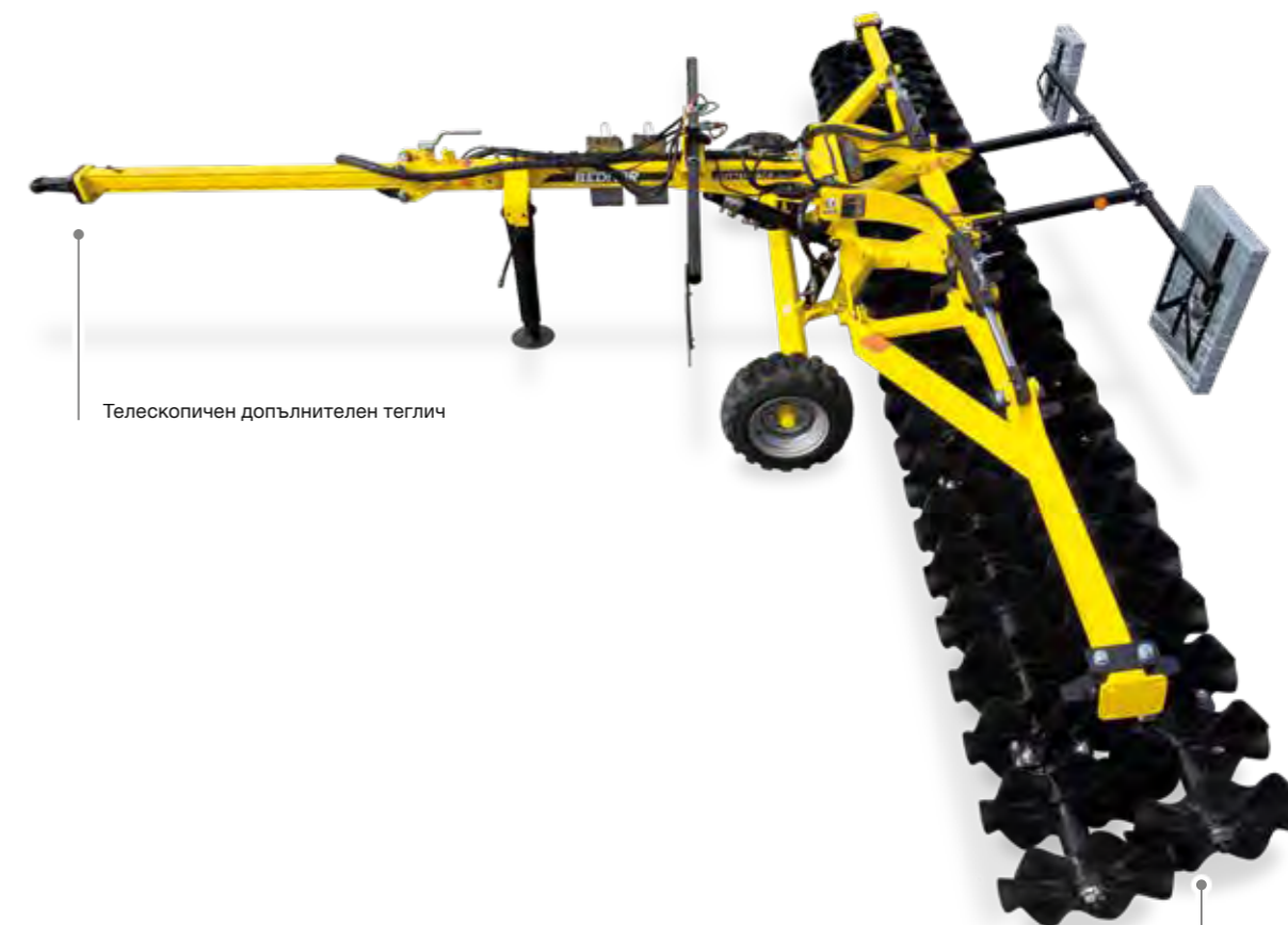
2 реда режещи дискове (520 x 5 мм) с ефект на самопочистване
