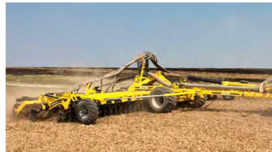
Porosty pro zelené hnojení lze zakládat velice rychle propojením FERTI-BOXU s širokozáběrovým diskovým podmičáčem SWIFTERDISC XE 10000 nebo XE 12000.
