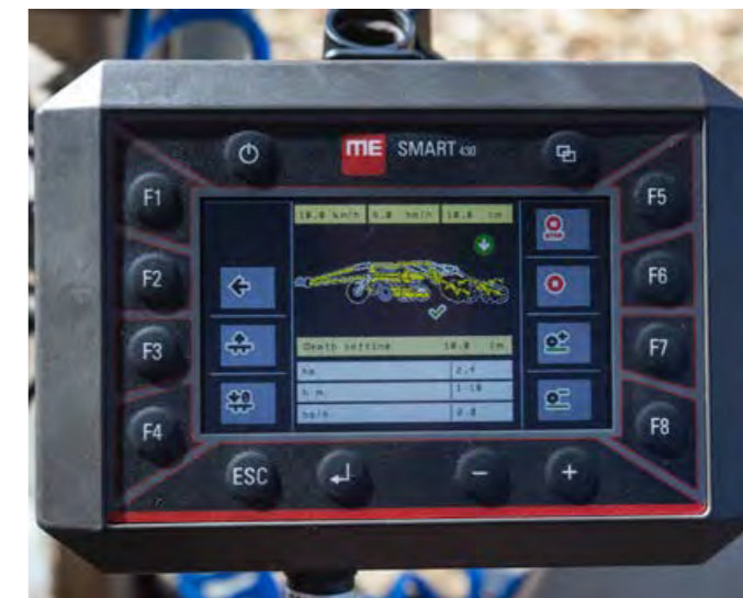
Load Sensing a elektrohydraulické ovládání pro model SWIFTERDISC XE 12 400 PROFÍ.
