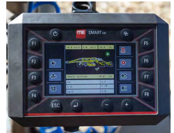
Load Sensing und elektrohydraulische Steuerung für SWIFTERDISC XE 12 400 PROFIL.
