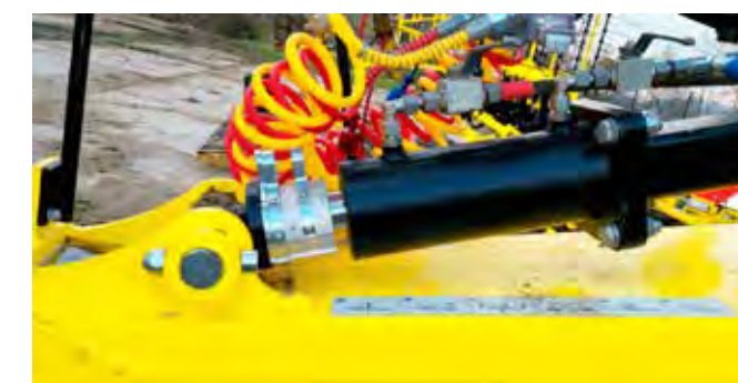
BARRA DE TIRO AJUSTABLE HIDRÁULICAMENTE
