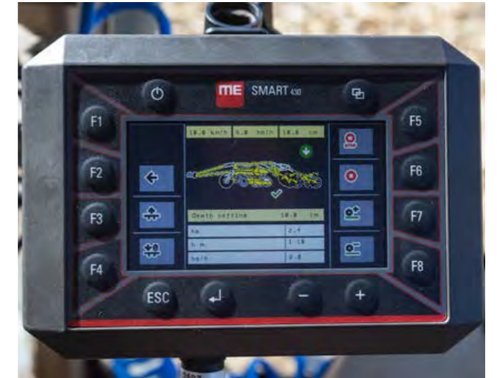
Load Sensing et contrôle électrohydraulique pour le modèle SWIFTERDISC XE 12 400 PROFIL.
