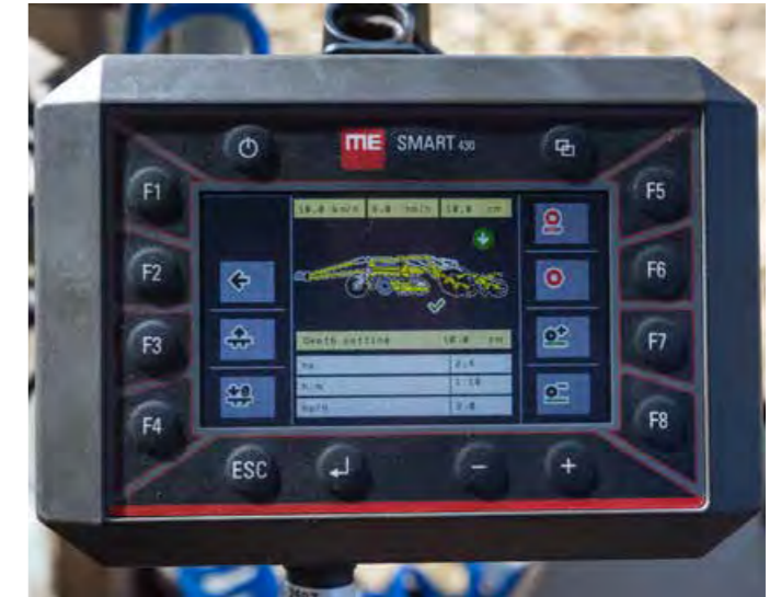
Load Sensing és elektrohidraulikus gépvezérlés a SWIFTERDISC XE 12400 PROFI-hez
