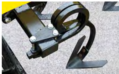
2 rzędy gęsiostopek z elastyczną słupicą
