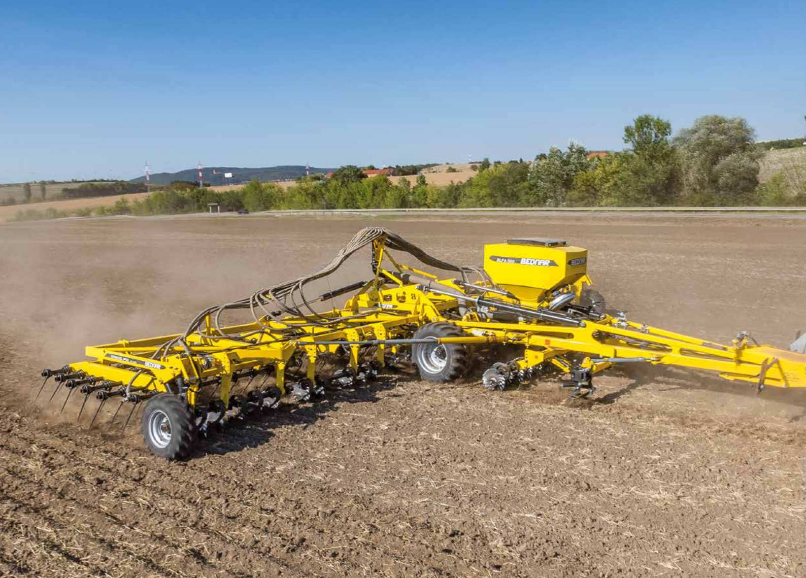
Szybkie i tanie sianie poplonu przy użyciu brony do słomy STRIEGEL-PRO z siewnikiem ALFA DRILL 800
