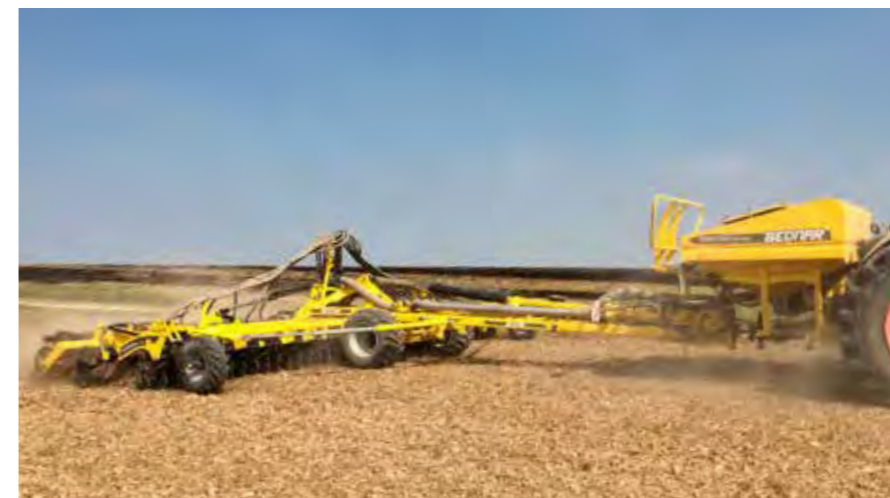
Naturalne nawożenie można w prosty sposób założyć przez zastosowanie zbiornika FERTI-BOX podłączonego do brony talerzowej SWIFTERDISC XE 10000 lub XE 12000.
