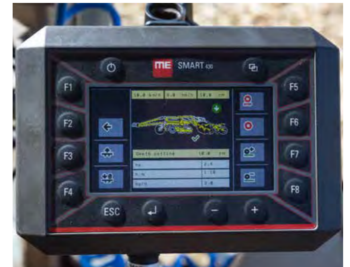
Load Sensing și control electro-hidraulic a întregului utilaj SWIFTERDISC XE 12400 PROFİ
