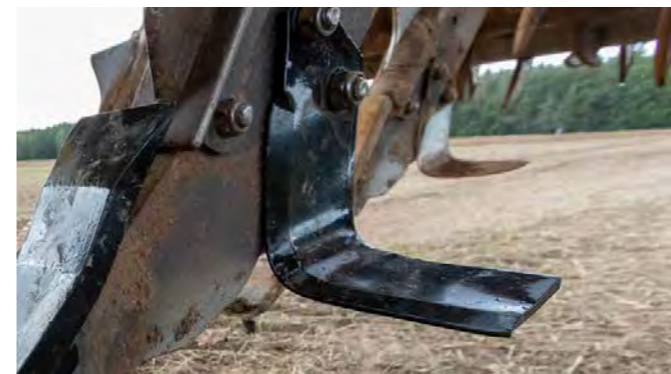
Comparație aripioară standard după 44 ha
