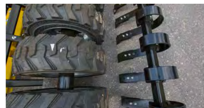
Пневматический каток FrontPack + CRUSHBAR выравнивающая планка
