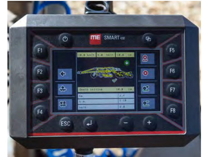
Load Sensing и электрогидравлическое управление агрегата SWIFTERDISC XE 12 400 PROFi.
