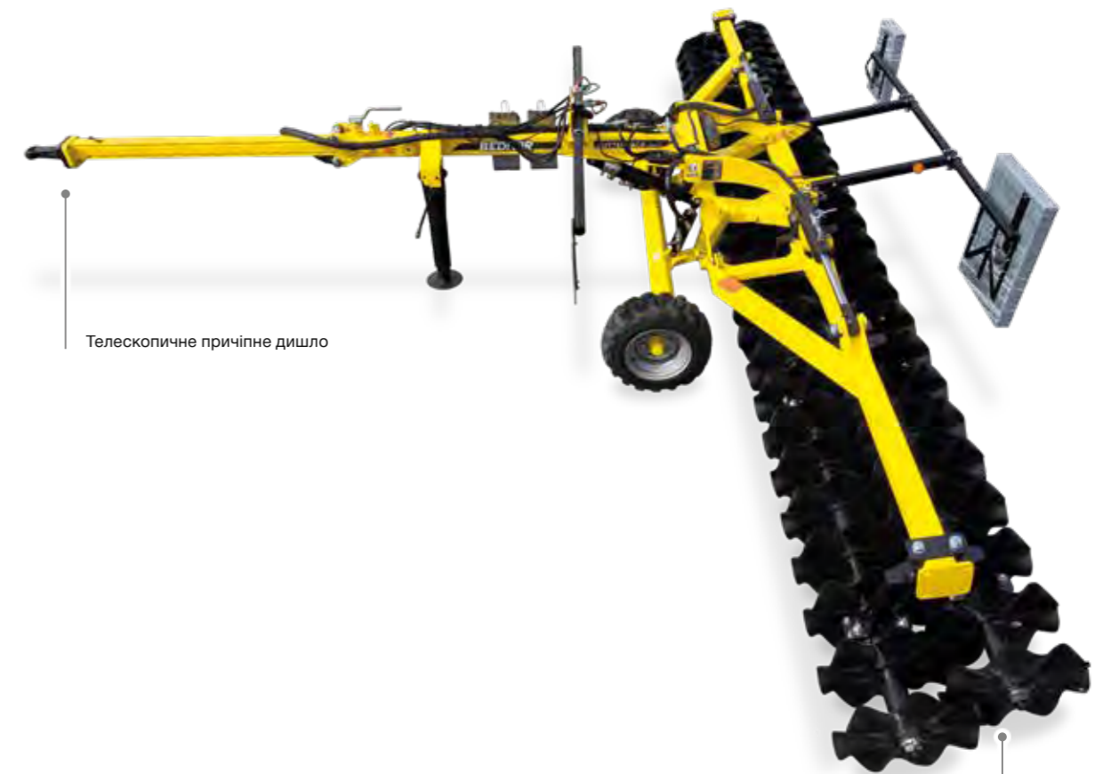
2 ряди ріжучих дисків (520 x 5 мм) з функцією самоочищення
