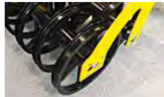
Подвійний U-ring коток 600 мм 8
